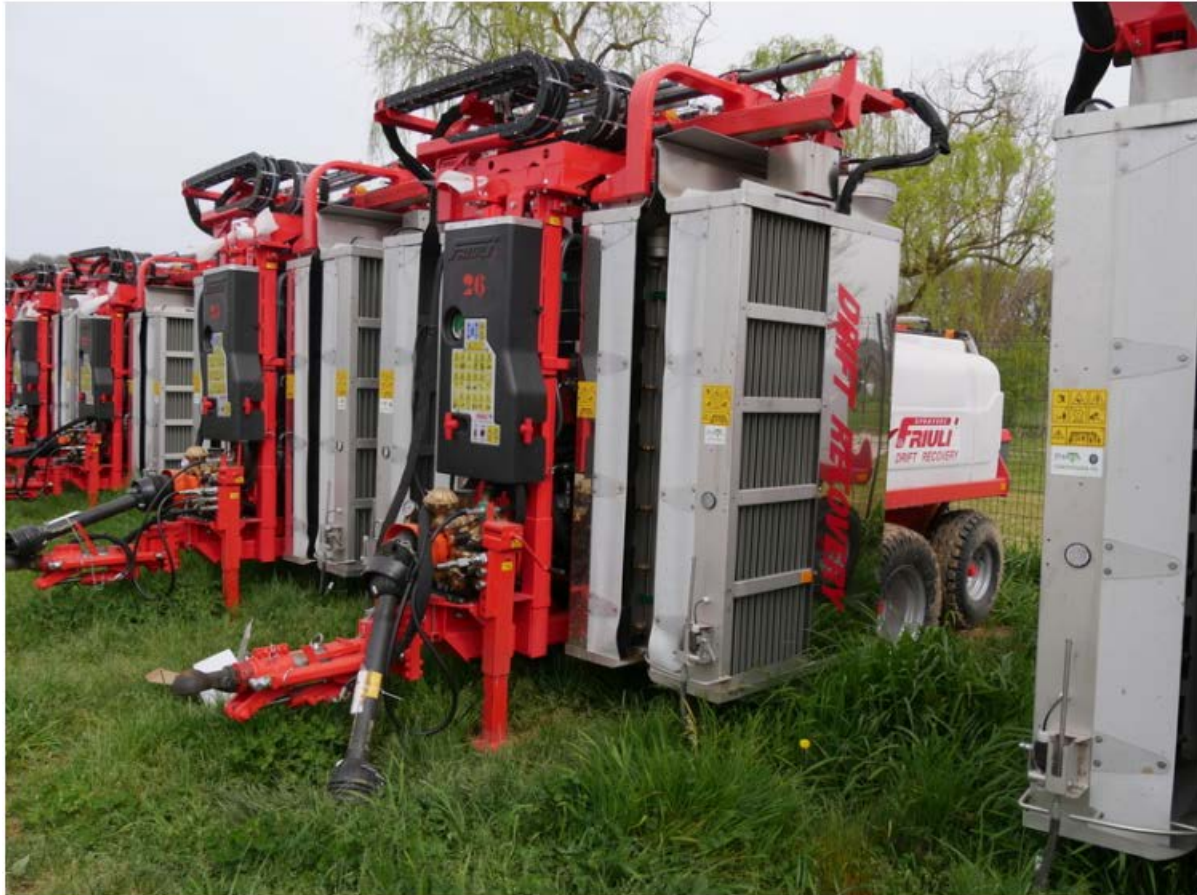
Les panneaux récupérateurs – le domaine est équipé de 45 Drift Recovery de Friuli – permettent une économie globale de 40 à 45 % d'intrants sur la campagne. © C. de Nadaillac
