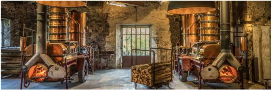
En moyenne, le débit d'un de ces alambics continus est de 15 hectolitres d'alcool pur par jour. - crédit photo : Victor Cornec (château du Tariquet)
